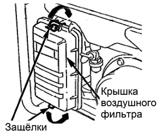
Рис. 21 Снятие крышки воздушного фильтра
