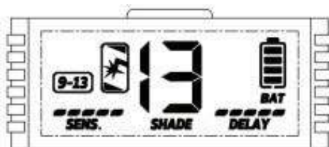
Рис. 7.2.2. Диапазон затемнения светофильтра 9-13 DIN.
